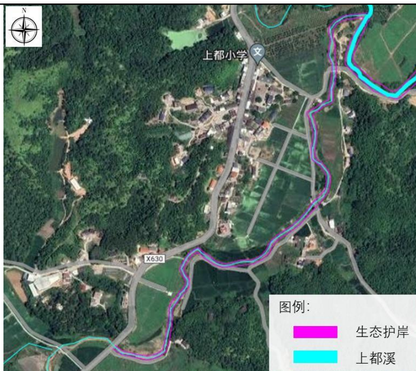
图 2-5 亲睦至瑞香村段生态护岸（中都溪）布置图
