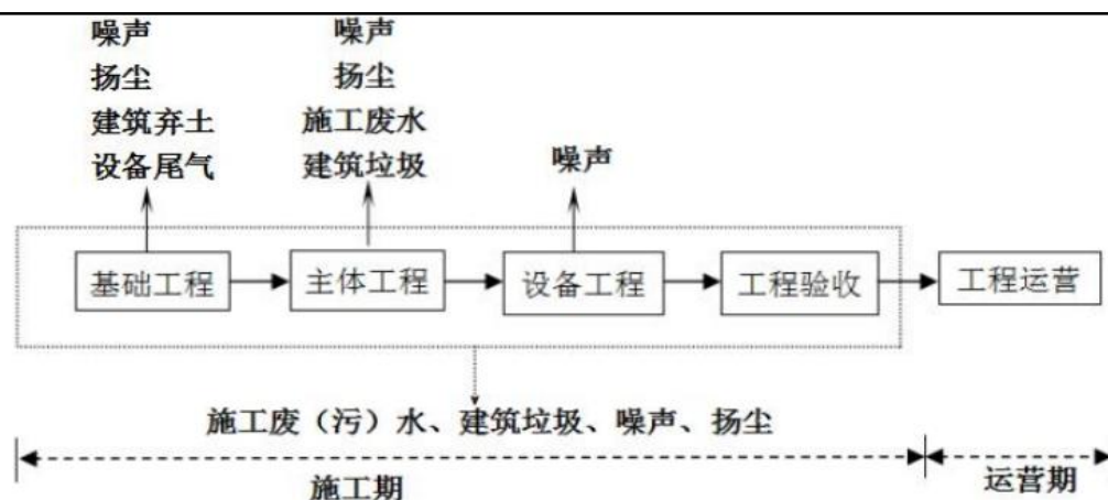
图 2-6 污水处理站施工流程及产污环节示意图
