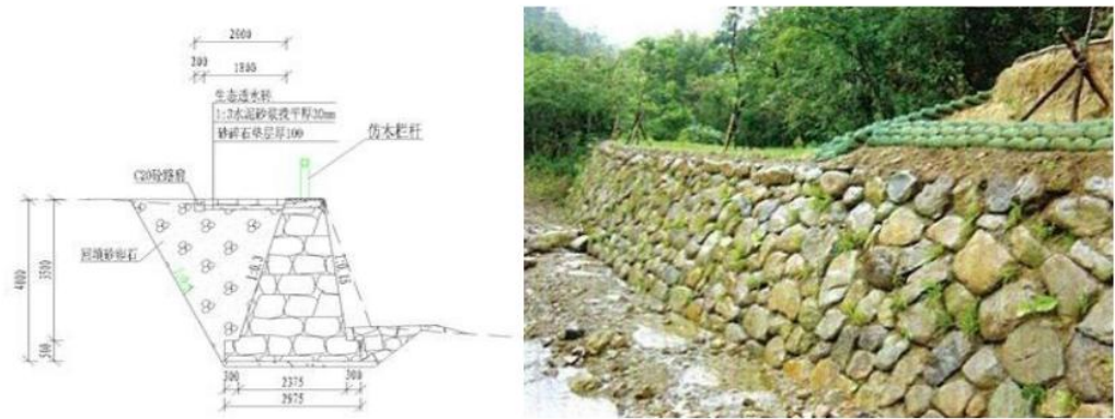
图 2-4 重力式浆砌块石护岸示意图
